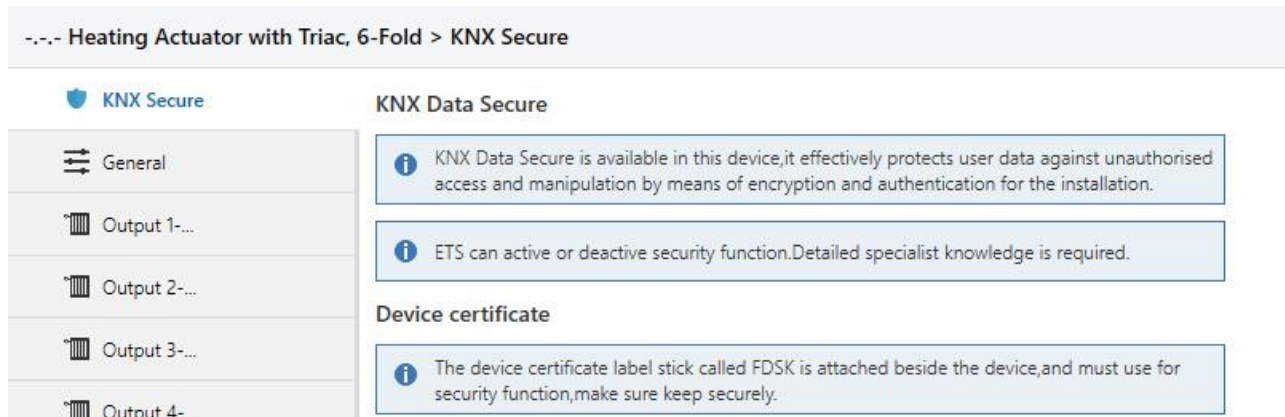
图 5.1 (1) “KNX Secure” 参数界面
