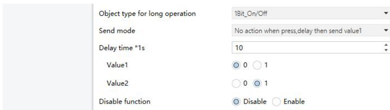
图 5.14 参数设置界面“Button x- Delay mode”(区分长短操作)
